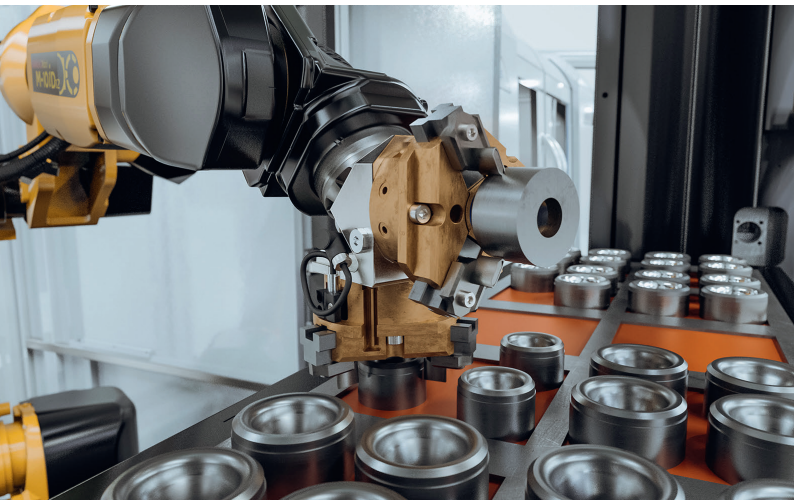
5 Der Industrieroboter des roboLoad nach der Aufnahme zweier Rohteile; unten sind Fertigteile aufgereiht © Studer
