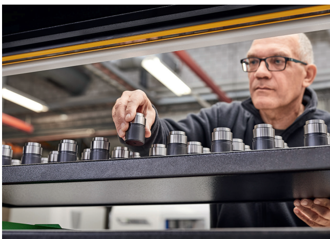
3 Eine der sechs jeweils 1080 mm × 320 mm großen Ablagen beim manuellen Bestücken mit Rohteilen © Studer
