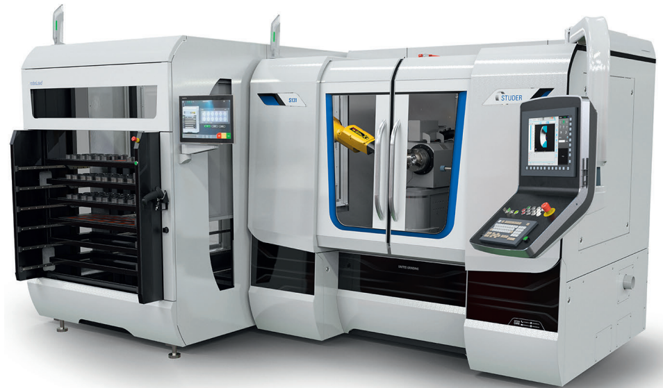
2 Beispielhaft: Automatisierte Zelle aus einer CNC-Radien-Innenrundschleifmaschine 'S131 Radius' und einem Ladesystem roboLoad © Studer
